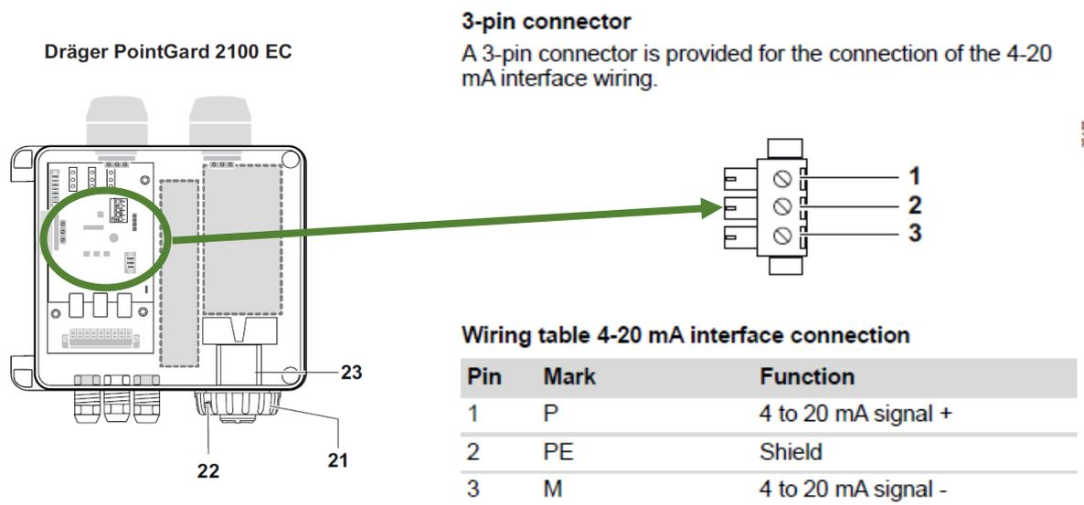
L'uscita 4-20 mA sarà impiegata per la trasmissione della lettura in continuo al PLC .
